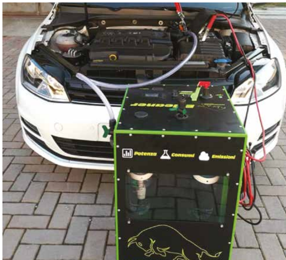
IL MACCHINARIO IN FUNZIONE SI COLLEGA DIRETTAMENTE ALLA BATTERIA DELL'AUTO, E TRAMITE UN TUBICINO INSERITO NEL CONDOTTO DI ASPIRAZIONE, VIENE ASPIRATO L'IDROGENO NECESSARIO PER LA PULIZIA DEL MOTORE.
